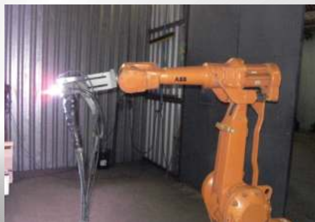
Robô aplicando revestimento a Plasma
