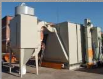
Foto 3 - Cabine de jateamento tipo móvel, sobre piso
