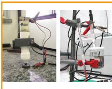
Figura 1 – Comparação entre a célula de ensaio de campo (esquerda) e a célula de ensaio convencional
