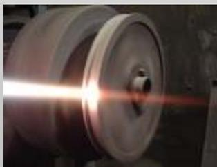
foram avaliados através de análise metalográfica, medidas de microdureza, ensaios de desgaste, adesão e rugosidade do revestimento depositado pelo processo HP-HVOF em substrato de aço carbono. É possível identificar a existência de uma vasta gama de
